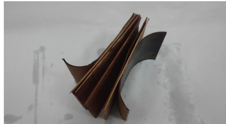
木制生态板---H15mm，经高温沸水处理24小时后两侧出现开裂分层翘曲现象，24小时后板材完全分散开。
