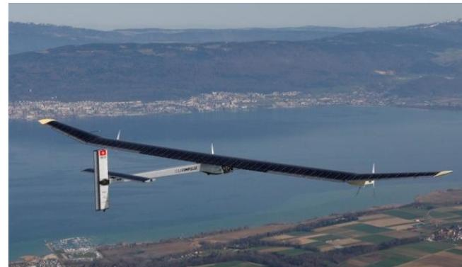
值得一提的是，为降低飞机自身重量、有效提升隔热性能，在“阳光动力”号飞机的驾驶舱覆层、发动机罩和机翼中，均采用了普恩公司 (Puren GmbH) 研发的超轻型改性PIR硬质聚氨酯泡沫
